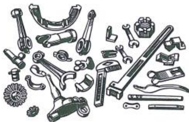
Рис. 2. Заготовки, обрабатываемые наружным протягиванием
